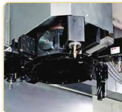
VT-V760CV с револьверной головкой Sauter
